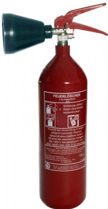
Tip: CO2-2 Volumen polnjenja z CO2: 2 kg Skupna teža: cca. 5 kg Višina: 500 mm Čas delovanja: 8,3 s Področje delovanja: -30°C do +60°C Tip požara: B
